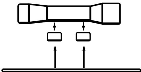
Чтобы выровнять склеиваемые детали, вставьте шкант в отверстие
